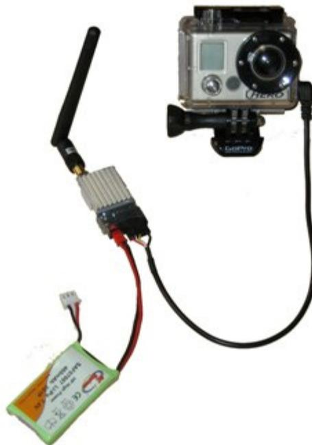
Connexion de l'émetteur à une caméra/microphone:
