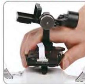
4.3 Mettez en place la nacelle en la glissant sur son rail. La nacelle doit se glisser de l'avant vers l'arrière de l'hexacoptère. Poussez la nacelle jusqu'à l'extrémité du rail.
