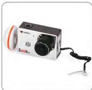
5.1 Vissez l'antenne « champignon » dans la caméra. Utilisez la clé plate fournie pour vissez l'antenne, ne forcez pas.
