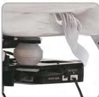
5.4 Insérez le connecteur de la caméra dans la prise d'alimentation située sur la nacelle G-3D.
