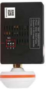
Interrupteur de sélection des canaux
