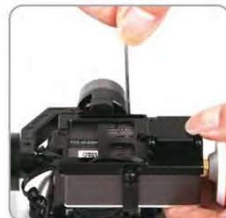
5.3 Installez la caméra dans le support de la nacelle, fixez-la ensuite à l'aide de la fixation et de deux vis M2x4 (assurez-vous que l'encoche de la fixation soit contre l'objectif de la caméra).
