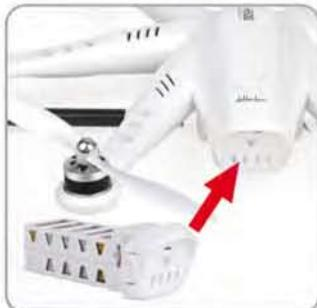
2.1 Installez la batterie complètement chargée. Inutile de mettre la batterie sous tension.
