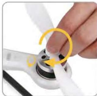
1.2 Respectez le sens de rotation en vissant chaque hélice correspondant à son rotor. Le symbole figurant sur l'hélice et celui représenté sur le bras du rotor doivent correspondre (les deux hélices doivent tourner dans le même sens). Vissez chaque hélice sur le moteur correspondant, vissez-les à la main, n'utilisez pas d'outil.
