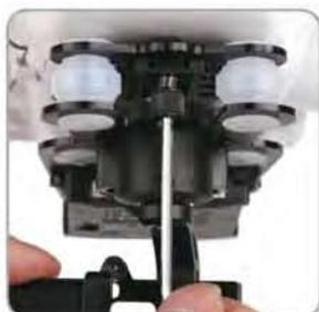
4.4 Logez le ressort dans la vis M3x12 puis vissez-la dans le trou fileté situé à l'avant de la nacelle. Cette vis a pour but de sécuriser la nacelle sur son rail.
