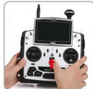
2.3 Mettez tous les interrupteurs de la Devo F12E sur la position 0 et déplacez le manche des gaz au plus bas (dans sa position minimale). Mettez ensuite l'émetteur sous tension.
