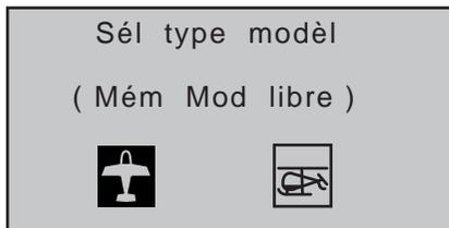
Dans notre exemple, nous confirmons l'enregistrement d'un modèle à voilure fixe, nous sélectionnons donc le symbole du modèle à voilure fixe, en appuyant sur la touche centrale **SET** de la touche droite. L'écran revient alors à l'affichage initial.
