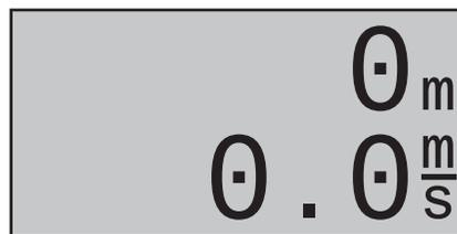
Cette page permet de visualiser les données provenant du Vario intégré d'un module GPS/Vario (Réf.Cde **33600**) en mètres relatives à l'altitude par rapport au point de décollage, ainsi que les taux actuels de montée et de chute en m/s.
