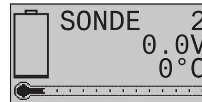
Cette page permet de visualiser la tension et la température actuelle d'une sonde de température et de tension (Réf.Cde **33612** et/ou **33613**) branchée sur la sortie «T(EMP)2» d'un module General Engine (Réf.Cde **33610**) ou d'un module General Air (Réf.Cde. **33611**).
