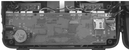
Cette pile évite la perte de la date et de l'heure lorsque l'alimentation de l'émetteur est interrompue, par exemple, pour un remplacement de l'accu.
