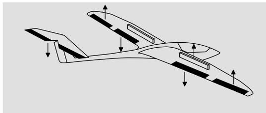
Le mixage des ailerons et des volets de courbure ainsi que de la profondeur permet de contrôler la descente lors de l'atterrissage (la position Butterfly est souvent utilisée à la place des aérofreins classiques).
