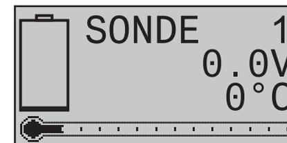
Cette page permet de visualiser la tension et la température actuelle d'une sonde de température et de tension (Réf.Cde **33612** et/ou **33613**) branchée sur la sortie «T(EMP)1» d'un module General Engine (Réf.Cde **33610**) ou d'un module General Air (Réf.Cde. **33611**).
