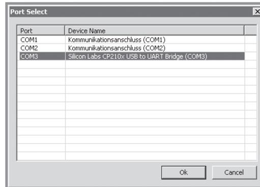
Dans la fenêtre « Port select » sélectionnez le Port COM correct sur lequel est branché le port USB. Celui-ci est reconnaissable à sa désignation « Silicon Labs CP210x USB to UART Bridge », dans la colonne « Device Name ». Dans la vue ci-dessus, il s'agit du Port «COM 3».
