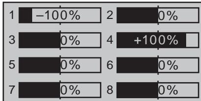
La position de chaque servo est représentée sous forme d'une jauge horizontale, exactement entre -150% et +150% de la course normale, et cette représentation tient compte des réglages des éléments de commande et des servos, des fonctions Dual-Rate-/Expo, de l'interaction des différents mixages, etc.. 0% correspond à la position neutre du servo. Vous pouvez ainsi vérifier rapidement vos réglages, sans allumer le récepteur.
