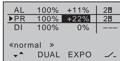
Une impulsion simultanée sur les flèches ▲ ▼ ou ◀ ▶ de la touche droite (**CLEAR**) remet les paramètres modifiés, dans le champ en surbrillance, à 0%.
