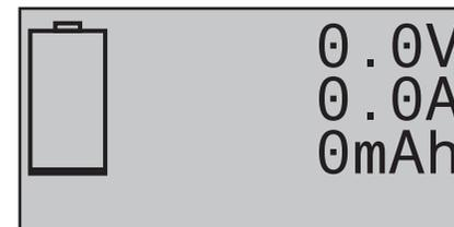
Cette page permet de visualiser la tension actuelle, la consommation actuelle et la capacité consommée par un accu branché sur la sortie Accu 1 d'un module Electric-Air (Réf.Cde. **33620**).
