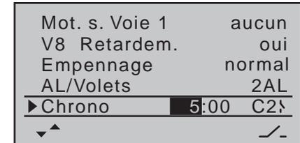
*Une fois sur l'affichage initial, et lorsque le chronomètre est arrêté, appuyez sur la touche centrale **ESC** de la touche gauche (**CLEAR**) pour que le chronomètre puisse se mettre en fonction « Timer » (décompte). Vous pourrez ensuite déclencher et arrêter le chronomètre avec l'élément de commande de la commande du moteur.*
