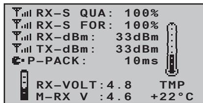
Vous pouvez passer d'un capteur activé dans le sous-menu « **APPELER SONDE** » du menu de « **Télémétrie** » à l'autre, en appuyant brièvement sur une des flèches de la touche gauche ou droite ...
