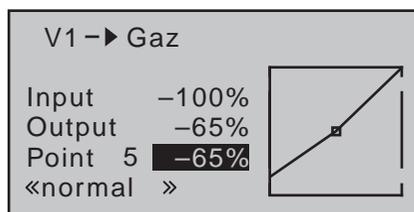
Avec Gazlimiter *fermé* et trim de ralenti complètement ouvert, déplacez plusieurs fois le manche de commande du Pas autour de la butée minimum. Le servo des gaz ne doit pas bouger. Vous réalisez là un passage tout en douceur du trim de ralenti à la courbe des gaz. Les autres réglages le long de la courbe des gaz doivent être effectués par la suite, en vol.
