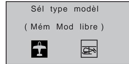
Choisissez maintenant avec les touches ◀ ou ▶ de la touche gauche ou droite le type de modèle de base, puis effleurez la touche centrale **SET** de la touche de droite. Ainsi, la mémoire sélectionnée est initialisée, avec le type de modèle choisi, et l'écran se remet sur l'affichage initial. L'emplacement de cette mémoire est maintenant « réservé ».
