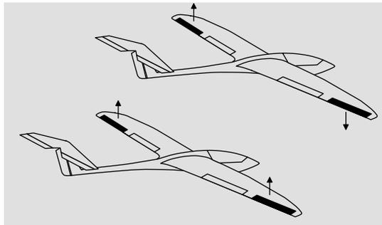
Dans un tel cas, il faut décaler les palonniers des servos, en partant du neutre, d'un cran vers l'avant, c'est-à-dire vers le nez de l'appareil.
