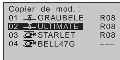
... une nouvelle impulsion sur la touche **SET** de la touche droite dans la fenêtre « Copier vers modèle : » pour sélectionner la mémoire d'arrivée avec les flèches ▲ ▼ de la touche de gauche ou de droite et confirmer avec **SET** ou interrompre la procédure avec **ESC**. Un emplacement de mémoire déjà occupé, peut être « écrasé ».
