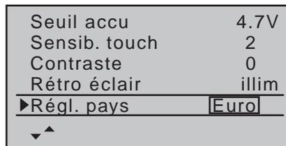
Ce réglage pays est nécessaire pour respecter les diverses législations et directives, (FCC, ETSI, IC etc.) en vigueur dans les différents pays. En France, par exemple, l'utilisation d'une telle radiocommande n'est autorisée que dans une plage de fréquence restreinte. C'est pourquoi, **si vous utilisez l'émetteur en France, il FAUT mettre l'émetteur en mode « France »**. Vous ne pouvez en aucun cas utiliser le mode Universal/EURO !
