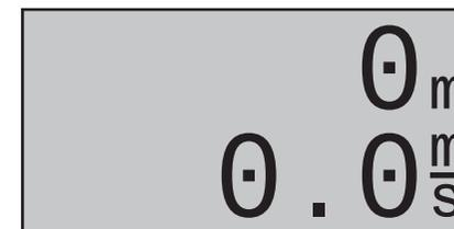
Cette page permet de visualiser les données d'un module Vario (Réf.Cde **33601**) branché sur une sortie téléométrique du récepteur en mètres relatives à l'altitude par rapport au point de décollage, ainsi que les taux actuels de montée et de chute en m/s.
