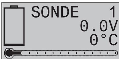
Cette page permet de visualiser la tension et la température actuelle d'une sonde de température et de tension Réf. Cde. **33612** et/ou **33613** branchée sur la sortie « T(EMP)1 » d'un module General Air (Réf.Cde. **33620**).
