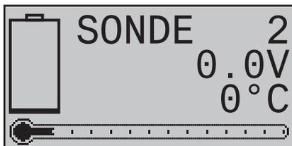
Cette page permet de visualiser la tension et la température actuelle d'une sonde de température et de tension (Réf.Cde **33612** et/ou **33613**) branchée sur la sortie « T(EMP)2 » d'un module General Air (Réf.Cde. **33620**).
