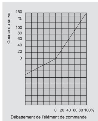
La vue ci-contre représente un exemple de réglage de course asymétrique d'un servo : - 50% et +150%
