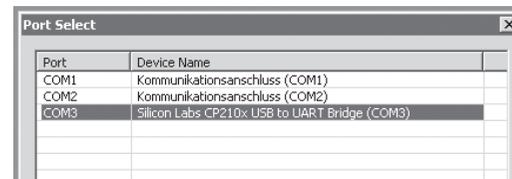
Dans la fenêtre « Port select » sélectionnez le Port COM correct sur lequel le port USB est branché. Celui-ci est reconnaissable à sa dénomination « Silicon Labs CP210x USB to UART Bridge » dans la colonne « Device Name ». Dans la vue ci-dessus, il s'agirait du port « COM 3 ».
