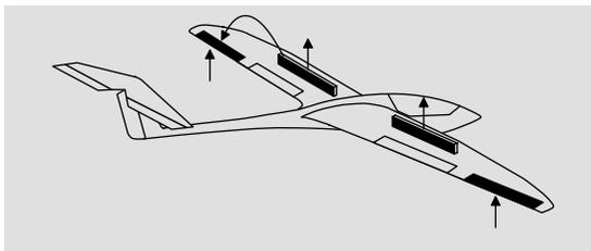
Avec ce mixage, lorsqu'on sort les aérofreins, la position des deux servos de commande des ailerons, réglables de -150% à +150%, est décalée, en phase d'atterrissage, en général, vers le haut.
