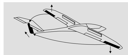
La direction, dans des proportions réglables, est entraînée par les ailerons ce qui permet, avec le différentiel aux ailerons, d'atténuer cet effet négatif et d'effectuer des virages « propres ». Par ailleurs la commande séparée de la direction reste toujours accessible.
