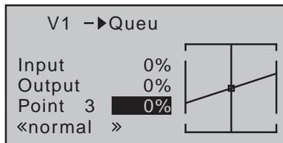
En partant d'une valeur de - 30% pour le point 1 et de + 30% pour le point 5, il faut régler son mixage de telle sorte que l'hélicoptère puisse maintenir son cap, c'est-à-dire qu'il ne tourne pas sur lui-même, autour de l'axe rotor, dans les longues montées ou dans les descentes, l'effet gyroscopique n'étant plus le même par rapport au Stationnaire. En vol stationnaire, on ne devrait utiliser que le trim (digital) de la commande de l'anti couple.
