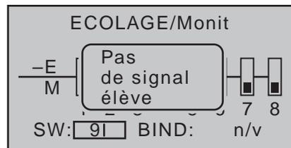
A cette étape de la programmation du système écolage sans fils, il est peu probable qu'un émetteur élève soit déjà relié à l'émetteur moniteur, l'émetteur réagira alors immédiatement au basculement de l'interrupteur par un message d'alerte visuel et sonore. Basculez alors de nouveau l'interrupteur que vous venez d'attribuer dans l'autre sens :
