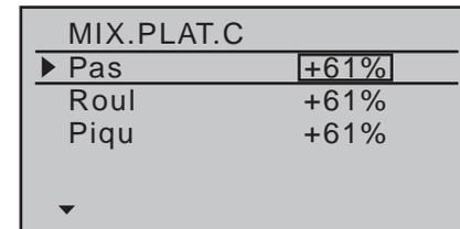
... et sont pré-réglés à +61% pour chacun des servos. Si le déplacement du plateau cyclique ne devait pas suivre correctement les ordres de commande des manches, inversez dans un premier temps le sens du mixage de « + » vers « - » avant d'inverser le sens de rotation des
