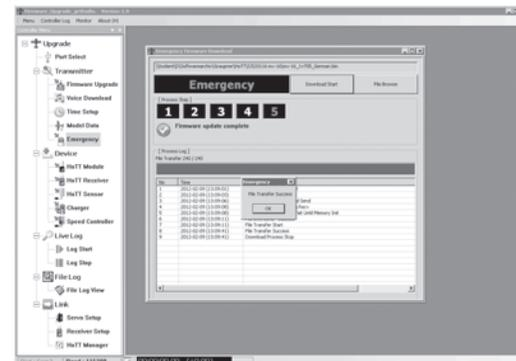
L'émetteur émet une mélodie, l'écran inférieur de l'émetteur s'allume avec sur la page d'ouverture « **mx-16** HoTT » et la version Firmware actuelle. Cliquez sur « OK ». Coupez ensuite l'émetteur, et déconnectez l'émetteur du PC ou du portable.
