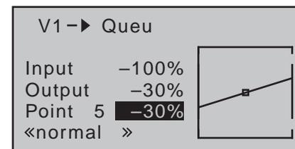
Pour essai, passez en phase Autorotation. Là aussi le réglage est désactivé, le servo de commande de l'anti couple ne réagit plus changement de Pas (car lorsque le moteur est à l'arrêt et que les pales du rotor ne tournent pas, il n'y a pas l'effet gyroscopique).
