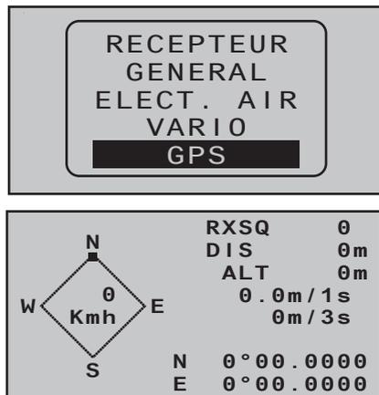
Cette page permet de visualiser les données d'un module GPS avec Vario intégré, Réf.Cde **33600**, branché sur le récepteur.
