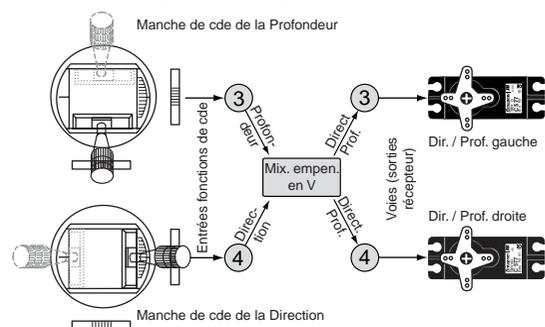
L'émetteur **mx-16** HoTT dispose de nombreux mixages prédéfinis, dans lesquels deux (ou plusieurs) voies sont mixées. Dans l'exemple cité ci-dessus, on peut ainsi activer le mixage dans la ligne « Empennage » du menu « **Réglages de base** » sous forme de « Empennage en V »
