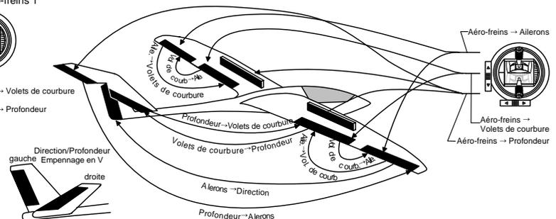
Affectation des sorties récepteur pour modèles ayant jusqu'à 2 servos d'ailerons, 2 servos de volets de courbure et un empennage de type « classique », empennage en V ou avec 2 servos de commande de la profondeur (3 + 8)
