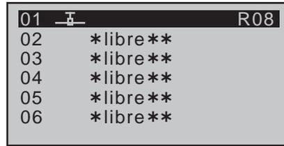
A la livraison de l'émetteur, la première mémoire de modèle est affectée au type « **Modèles à voilure fixe** », et le récepteur qui est fourni avec est déjà assigné à celle-ci. Reconnaisable à l'affichage récepteur en haut à droite. Dans l'exemple ci-dessus R08. Dans le cas d'une mémoire non assignée, apparait le sigle „---“.
