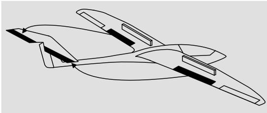
En actionnant les volets, que ce soit par le « **Trim de phases** » ou par un élément de commande attribué à la voie « E6 », des effets secondaires peuvent se produire, qui agissent sur l'axe transversal du modèle. Mais on peut également souhaiter que le modèle soit un peu plus rapide en relevant légèrement les volets. Ce mixage permet d'obtenir ces deux résultats.
