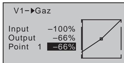
Pour un réglage *précis*, et une transition parfaite du trim de ralenti à la courbe des gaz, il faut déplacer plusieurs fois le manche de commande du Pas en position minimum quand Gazlimiter est entièrement fermé et le trim de ralenti complètement ouvert. Le servo de commande des gaz ne doit pas se déplacer ! Les autres adaptations de la courbe des gaz devront de toute façon être effectuées par la suite, en vol.
