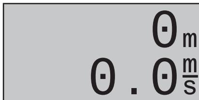
Cette page permet de visualiser les données du Vario intégré au module Electric Air (Réf.Cde **33620**) en mètres relatives à l'altitude par rapport au point de décollage, ainsi que les taux actuels de montée et de chute en m/s.
