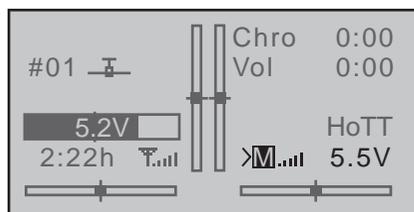
Dès dépassement du seuil mini, réglable, enregistré dans le menu de télémétrie page 146, d'origine réglé à 3,8 Volt, un message d'alerte s'affiche à l'écran en cas de tension trop faible, accompagné d'un signal sonore.
