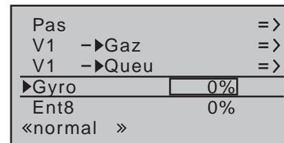
En partant des réglages Offset, spécifiques à chaque phase de vol, on peut en plus, faire varier la sensibilité du gyroscope, grâce à un élément de commande attribué dans la ligne « Gyro » du menu « Réglages des éléments de commande » (page 98), par exemple CTRL 8.
