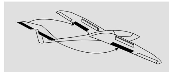
Pour compenser à la profondeur, lors des virages serrés ou en voltige, la fonction de commande des volets peut être entraînée, grâce à ce mixage, par la commande de la profondeur. Le sens du débattement doit être de telle sorte que lorsque vous tirez sur le manche de commande de la profondeur, les volets s'abaissent, et lorsque vous poussez sur le manche, ils doivent se relever. Ils doivent donc toujours fonctionner en sens inverse.
