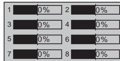
Sinon les jauges et les données en % correspondent à la position actuelle des manches de commandes crantés, cad ceux qui ne reviennent pas au neutre – en règle générale le manche de commande des gaz/aérofreins et/ou le manche de commande du Gaz/Pas «V1». Si par exemple le manche de cde du Gaz/Pas se trouve en position «1/4 des Gaz», l'affichage écran est le suivant :
