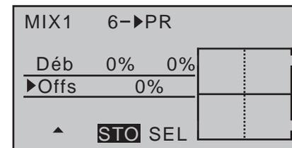
La ligne verticale pointillée, au milieu du graphique, indique la *position du point neutre* du mixage (« Offset »), c'est-à-dire, la position du point sur la course du manche de commande, point sur lequel le mixage n'agit PAS sur la voie de commande. En règle générale, ce point se trouve au milieu de la course.
