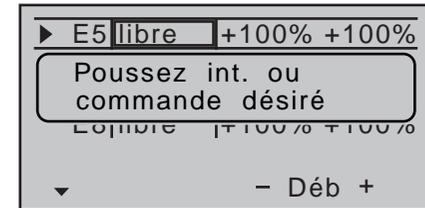
Déplacez maintenant l'élément de commande souhaité (CTRL 6 à 10), ou l'interrupteur choisi (SW 1 à 9) sachant que les boutons proportionnels ne seront reconnus qu'après plusieurs maniements. Si la course n'est pas suffisante, déplacez-le éventuellement dans l'autre sens.
