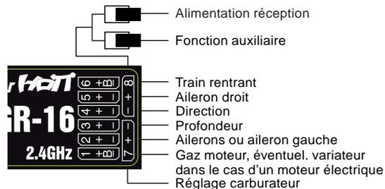
En attribuant les éléments de commande de l'émetteur aux voies auxiliaires l'émetteur, il faut veiller à ce que ceux-ci soient facilement et rapidement accessibles, car en compétition, vous n'avez pas trop le temps pour lâcher les manches.
