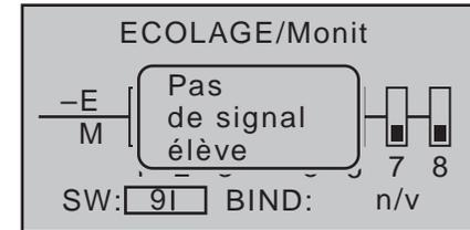
Comme nous ne sommes qu'au début de la programmation d'un système écolage, il est peu probable qu'un émetteur élève soit déjà relié à l'émetteur moniteur, l'émetteur réagira alors au basculement de l'interrupteur par un message d'alerte visuel et sonore. Basculez alors de nouveau l'interrupteur que vous venez d'attribuer dans l'autre sens:
