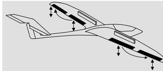
Pour obtenir une portance uniforme sur toute l'envergure de l'aile, une part de réglage de la commande des volets entre dans les voies 2 et 5 des ailerons. De ce fait, les ailerons bougent correctement lorsque les volets sont sortis, normalement avec un débattement moindre. La plage de réglage est de ±150%. Les valeurs de réglage pour ce type de mixage se situent à env. 50%.
