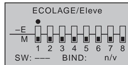
La vue ci-dessus vous montre la configuration du menu, au départ : rien encore n'a été attribué à l'élève, ni élément de commande (☐), ni interrupteur (SW : --- en bas à gauche, -E à gauche de la vue).
