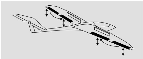
Avec ce mixage, on peut régler la part de mixage des ailerons qui entre dans la commande des volets. Les volets se déplacent alors de la même amplitude que les ailerons lorsqu'on actionne les ailerons. Mais normalement le débattement des volets doit être inférieur à celui des ailerons, cela signifie que la part de mixage est inférieure à 100%. La plage de réglage de -150% à +150% permet de régler le débattement des servos de commande des volets à celui des ailerons.
