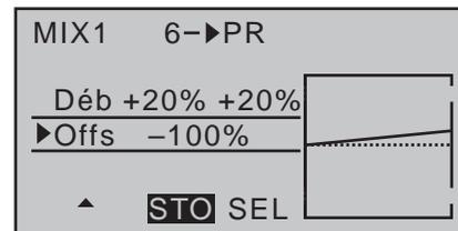
Si vous ramenez le point Offset de -75% à 0% de la course de commande en sélectionnant avec la flèche ► de la touche gauche ou droite le champ **SEL** et en appuyant simultanément sur les deux flèches ▲▼ ou ◀▶ de la touche droite (**CLEAR**), vous obtiendrez la configuration suivante :
