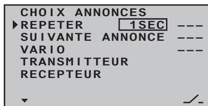
Pour pouvoir écouter les annonces par l'écouteur, il est nécessaire d'attribuer au moins un interrupteur dans la ligne « REPETER ». Cela se fait comme décrit en page 57, au paragraphe « Attribution des interrupteurs et des inters. sur manche » :
