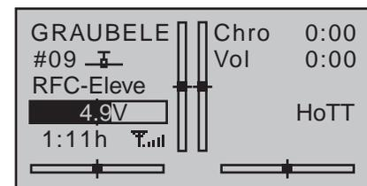
Si durant l'écolage, il devait y avoir une perte de liaison entre l'émetteur-moniteur et l'émetteur-élève, l'émetteur-moniteur reprend automatiquement le contrôle du modèle.
