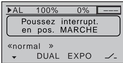
... et attribuez un interrupteur à cette fonction comme décrit en page 57, paragraphe « Attribution des interrupteurs et des inters sur manche ». A l'écran, l'interrupteur apparaît avec le symbole de l'interrupteur et en indique le sens de fonctionnement.
