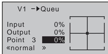
De manière standard, on fait appel à une courbe de compensation de l'effet gyroscopique avec une part de mixage linéaire de 0% comme cela doit être le cas pour un gyroscope fonctionnant en mode « Heading-lock » (verrouillage de cap), voir vue ci-dessus.
