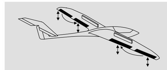
En sortant les aérofreins (manche de commande V1) on peut régler séparément une part de mixage volets pour l'atterrissage comprise entre -150% et +150%, en général, on les fait débattre vers le bas.
