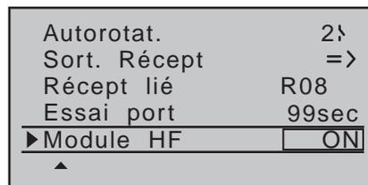
Avec les flèches de droite, vous pouvez maintenant sélectionner **OFF** ou **ON**. Une nouvelle impulsion sur la touche centrale **SET** de la touche droite permet de conclure l'enregistrement.
