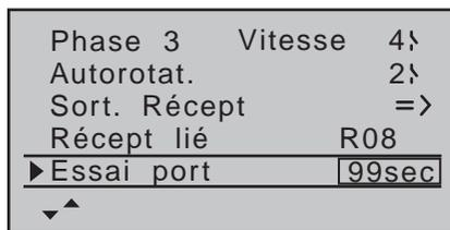
Le fait de déclencher l'essai de portée, réduit la puissance d'émission de l'émetteur de manière significative et la LED bleue au niveau du pied de l'antenne se met à clignoter. En même temps, le compte à rebours se déclenche à l'écran, et une double tonalité est émise toutes les 5 secondes.
