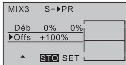
Avec la flèche ▲ de la touche gauche ou droite allez maintenant sur la ligne « Déb » puis appuyez sur la touche centrale SET de la touche droite. Dans les champs en surbrillance, avec les flèches de la touche droite, enregistrez la part de mixage nécessaire, après avoir basculé l'interrupteur souhaité en position Mixage ON.
