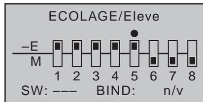
Pour pouvoir transmettre les commandes, il faudra encore attribuer, à droite de l'écran, un interrupteur réservé à l'écologie sur l'émetteur-moniteur. Avec les flèches de la touche quadridirectionnelle gauche ou droite, placez le repère en bas à gauche, à côté de « SW », et attribuez, comme décrit en page 57, un interrupteur.
