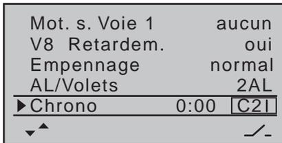
Après avoir activé l'attribution des interrupteurs avec une brève impulsion sur la touche centrale **SET** de la touche droite et après avoir sélectionné le champ au-dessus du symbole de l'interrupteur, déplacez le manche de commande des Gaz /Aérofreins de la position Ralenti en position « Plein Gaz ». Selon le sens du déplacement, vous verrez apparaître à l'écran, à une position bien précise du manche V1, « C1I » ou « C2I ». Si vous remettez maintenant le manche de commande
