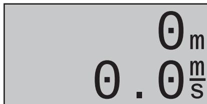
Cette page permet de visualiser les données du Vario intégré au module General Engine (Réf.Cde **33610**) ou au module General Air (Réf.Cde **33611**) en mètres relatives à l'altitude par rapport au point de décollage, ainsi que les taux actuels de montée et de chute en m/s.
