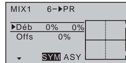
La ligne verticale représente la position actuelle de l'élément de commande de la voie 6. (sur le graphique ci-dessus, au bord gauche, car CTRL 7, comme évoqué plus haut, est en butée à gauche). la ligne horizontale indique la part de mixage, qui dans ce cas a une valeur nulle constante sur toute la course de l'élément de commande ; de ce fait il n'y aura pas de compensation à la profondeur lorsque les aérofreins sont sortis.
