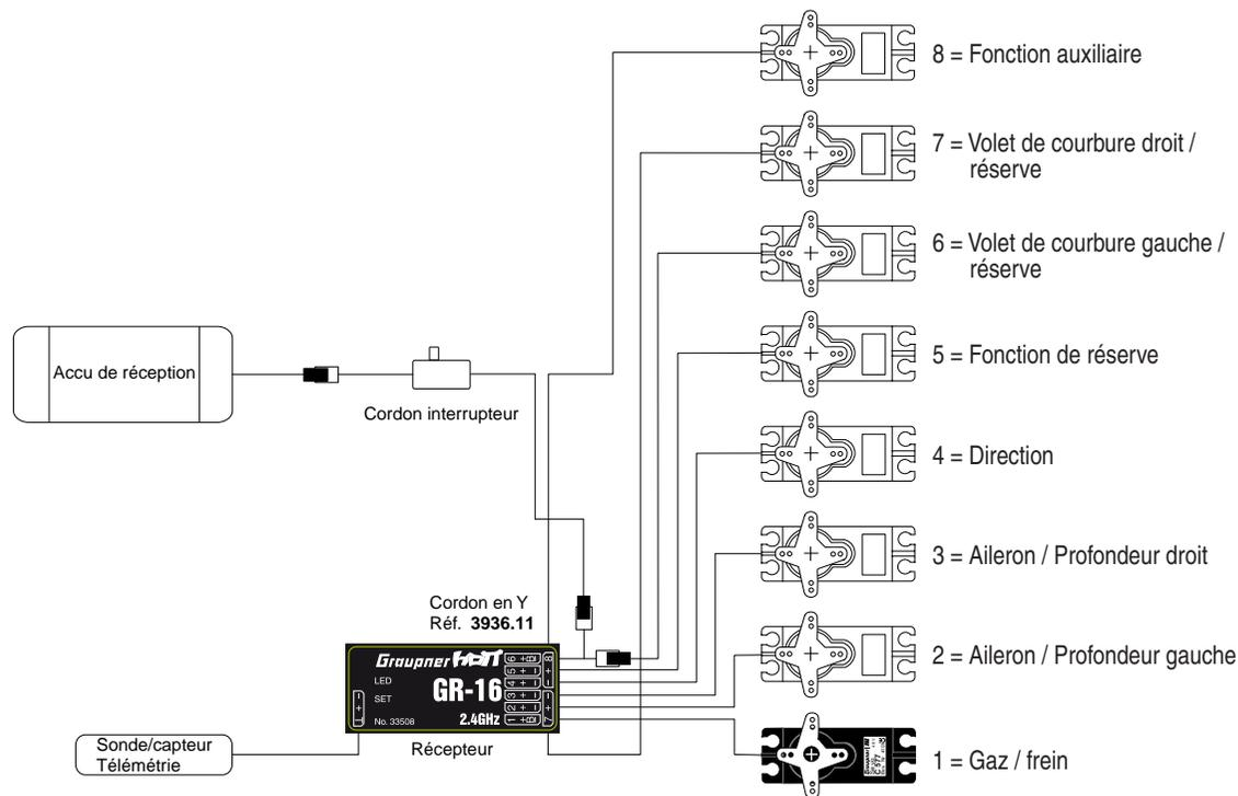
Etant donné les différents montages possibles des servos et la fixation des tringles de commande, il est tout à fait probable qu'il soit nécessaire d'inverser ici ou là le sens de rotation des servos. Le tableau ci-dessous donne quelques conseils bien pratiques :
