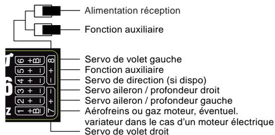
Pour des ailes volantes, avec les gouvernes de profondeur à l'intérieur de l'aile et les modèles de type « canard » c'est l'attribution « classique » qui s'avère la meilleure :
