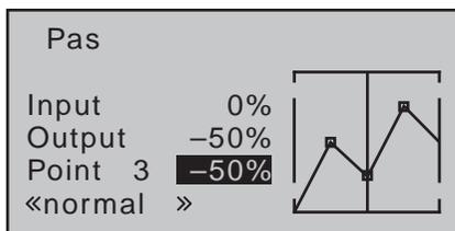
Exemples de courbe de commande de Pas pour différentes phases de vol :
