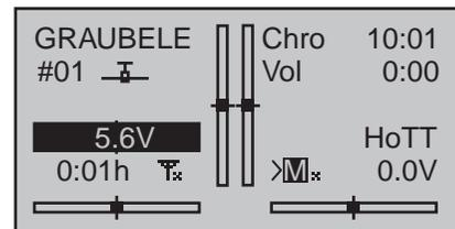
Le chronomètre démarre après avoir actionné l'interrupteur attribué, à la valeur que vous avez enregistrée, en décomptant le temps – compte à rebours – (« Fonction Timer »). Mais une fois le temps écoulé, le Timer ne s'arrête pas, pour pouvoir encore lire le temps écoulé après 0:00. Pour plus de clarté, le temps après le passage du zéro, est affiché en surbrillance.
