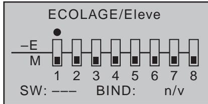
La vue ci-dessus vous montre la configuration du menu, au départ : rien encore n'a été attribué à l'élève, ni élément de commande (M), ni interrupteur (SW : --- en bas à gauche, -E à gauche de la vue).
