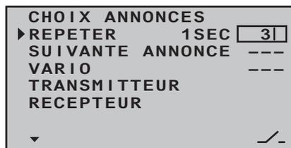
Avec cet interrupteur, vous pouvez reécouter le dernier message pour la durée qui est indiquée à gauche de l'interrupteur, tant que l'interrupteur qui y est attribué est fermé.
