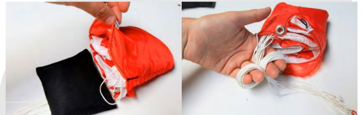
Pour conditionner les suspentes dans le container, les saisir et effectuer un 8 à l'aide de vos doigts. Insérez ensuite l'ensemble des suspentes devant le bord de fuite du parachute.
