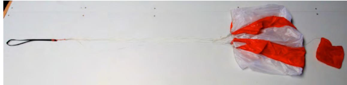
Dans un premier temps, bien étaler le secours et s'assurer qu'aucune suspente ne passe au-dessus d'une autre suspente. Effectuez quelques gonflages.
