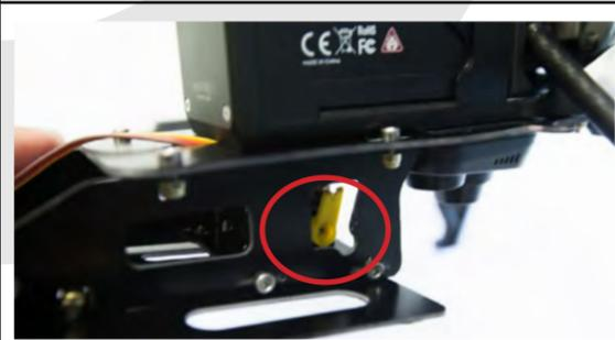
Positionnez ensuite le servomoteur en position basse (position "éjection du parachute"). Vérifiez que le palonnier ne force pas sur la platine. Il doit y avoir un écart d'environ 1mm. Ajustez ce jeu sur votre module de déclenchement autonome ou sur votre ensemble Tx / Rx.
