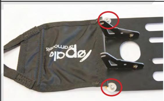
Préparez la sangle d'éjection. Utilisez une vis CHC M3-8, une rondelle classique et un écrou frein M3. L'insérer dans le plus petit des deux anneaux.
