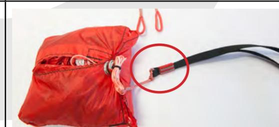
Une fois la sangle noire retirée, passez à l'étape suivante de fixation du parachute sur les deux sangles préalablement apposées sur la machine
