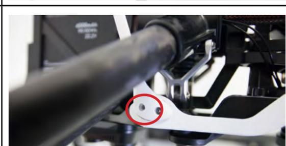
Utiliser les 2 vis Torx précédemment retirées pour fixer la platine sur le châssis.
