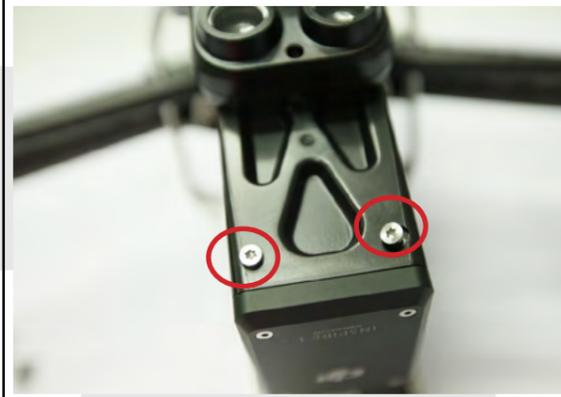
Installer le 1er flanc latéral sur la platine principale à l'aide de 2x Vis CHC M3-8 et 2x 2 écrous freins M3.
