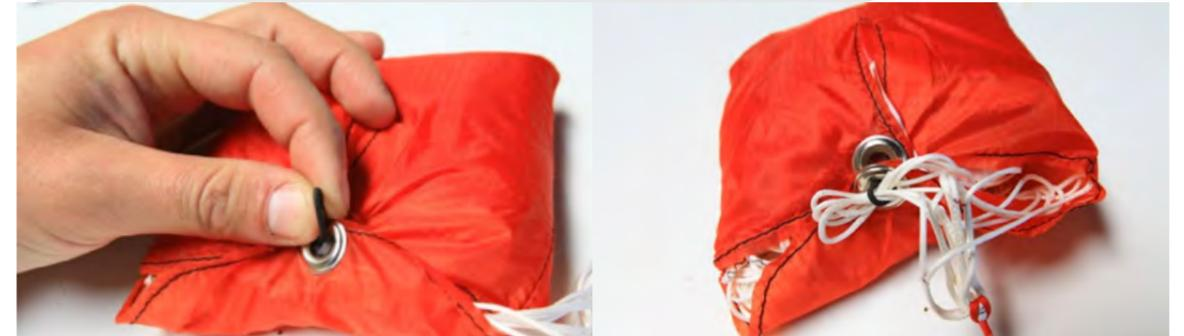
Une fois le volet fermé, passez 2 à 3 suspentes afin de verrouiller l'ouverture.
