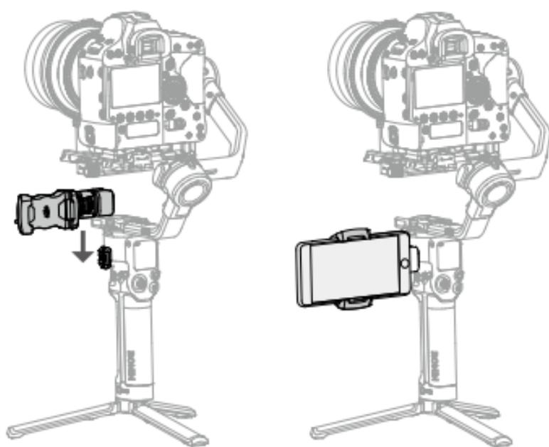
2. Logez le smartphone fermement dans le support pour smartphone et glissez-le sur la droite ou la gauche pour l'ajuster.
