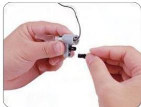
4. installez les hélices sur le drone.
