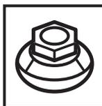
Resserrez l'écrou kingpin pour une conduite plus stable et plus rigide. Desserrez-le pour rendre la planche plus maniable et diminuer le rayon de braquage, pour des virages plus serrés.
