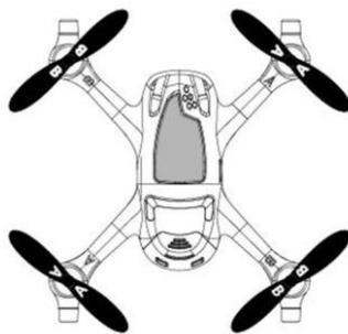
Note : Veuillez bien à respecter le sens des moteurs (voir schéma ci-dessus) au moment de mettre les hélices. On retrouve d'ailleurs les lettres A et B (sur les hélices) pour nous guider.
