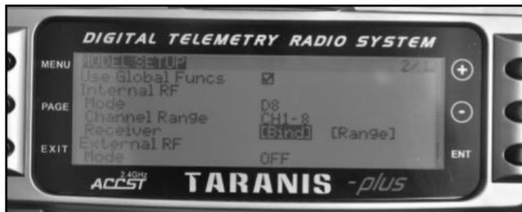
4. La lumière bleue va s'éteindre sur l'appareil, cela indique que le bindage a bien été effectué. Reconnectez la batterie sur le contrôleur de vol et la lumière bleue sera encore fixe. La connection sera donc établie avec votre émetteur.
