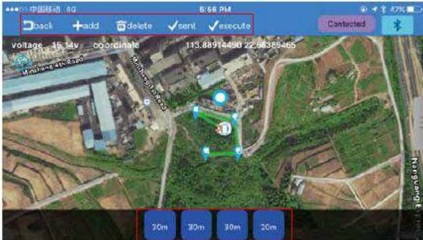
b). Sélectionnez les points de vol pour configurer l'altitude et le temps de passage sur chaque point et/ou en supprimer. Enregistrez et cliquez sur exécuter, et le drone commencera à effectuer son vol en fonction du chemin défini.
