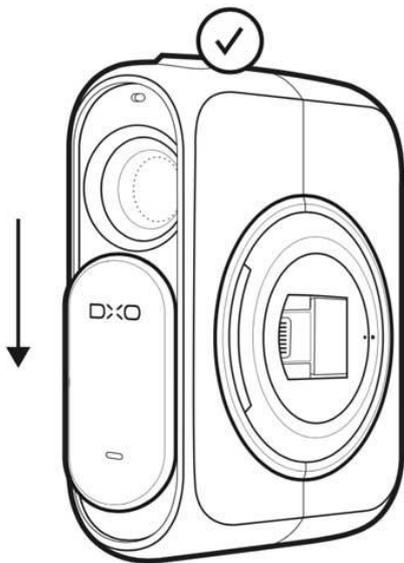
Avant d'installer la DxO ONE dans l'Outdoor Shell, assurez-vous que l'objectif est découvert (cache glissé vers le bas) et que le connecteur Lightning est rétracté (fermé).
