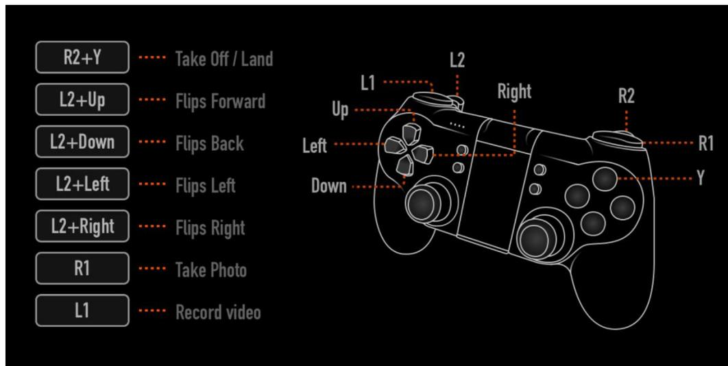
**Le drone RYZE DJI Tello fonctionnera avec les joysticks GameSir T1d/T1/T1s/G4/G4s.**
