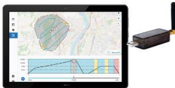
Figure 6 : Présentation de l'application mobile et son dongle USB LoRa®
