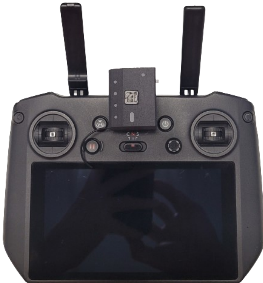
Figure 15 Télécommande de coupure moteur ABOT installée sur DJI RC Pro
