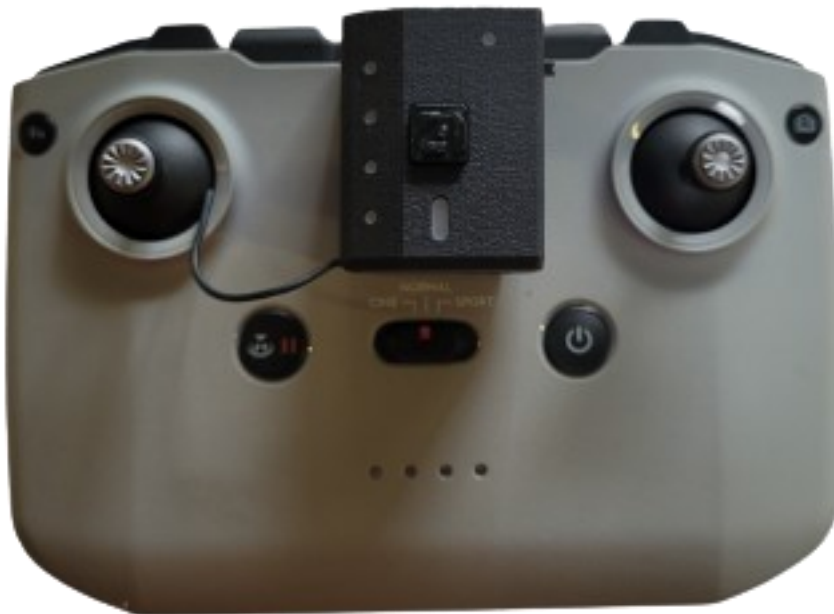
Figure 14 Télécommande de coupure moteur ABOT installée sur DJI RC-N1
