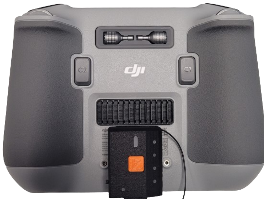
Figure 16 Télécommande de coupure moteur installée sur DJI RC
