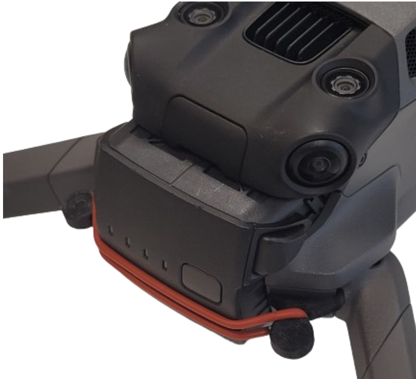
Figure 13 Mavic 3 Pro ou Mavic 3 Pro Cine équipé de la coupure moteur ABOT
